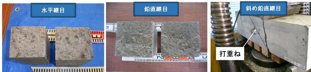
写真-1 コンクリートの破断面
